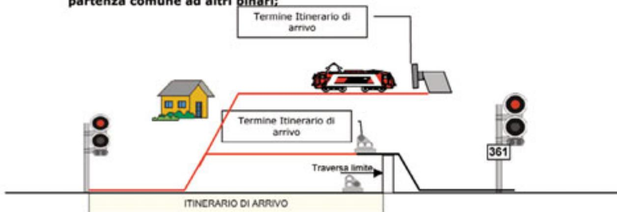
l'itinerario si estende dal segnale di 1ª cat. di protezione fino al primo ente (traversa limite, punta di deviatoio, paraurti di binario tronco, segnale di partenza) situato oltre il punto di normale fermata del treno di massima composizione ammesso a circolare sulla linea o, in mancanza di tale ente, fino all'anzidetto punto di normale fermata.
