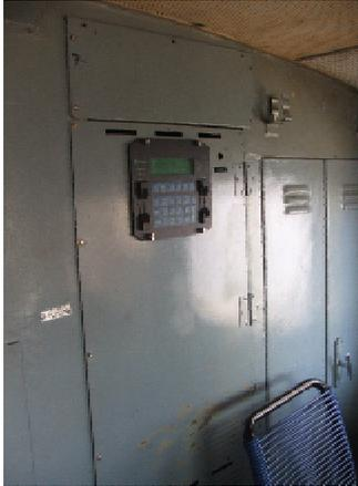
In cabina B, alle spalle del 1° agente, è posizionato il Terminale Remoto DIS
