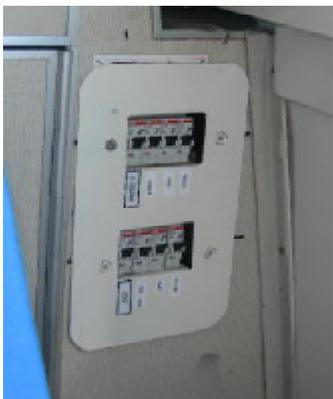
In cabina di guida, alle spalle del 1° agente, sono posti gli stotz relativi all'apparecchiatura DIS
