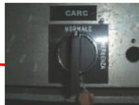
In cabina A, nel quadro BT, è posto il commutatore CARC per l'attivazione del terminale Cab-Radio in emergenza.
