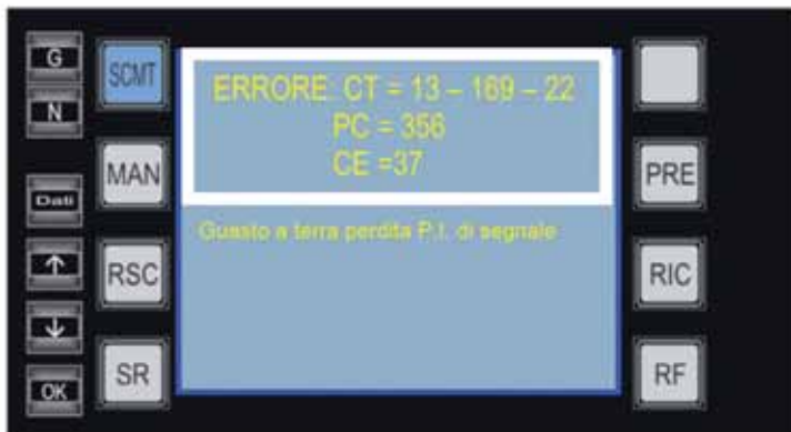
Fig. 3 codice errore ricevuto sul display di bordo all'arresto del convoglio.
