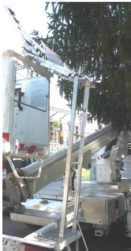
La DTP di FI ha realizzato, in partnership con una ditta costruttrice, alcuni prototipi da portare in sperimentazione negli impianti della UP, che garantiscono la salita con maggior sicurezza e un punto-vita di ancoraggio per lo svolgimento dell'attività sull'imperiale.
